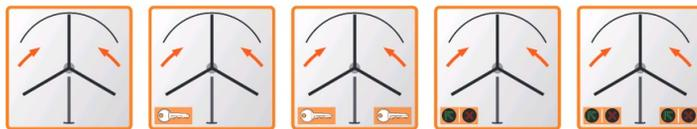
Libre de tourner dans les deux sens. Fermé ou ouvert dans un sens. Libre de tourner dans l'autre sens. Fermé ou ouvert dans les deux sens. Contrôle d'accès dans un sens, libre de tourner dans l'autre sens. Contrôle d'accès dans les deux sens.
